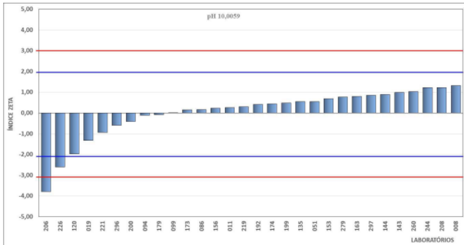
Figura 1 - Gráfico do índice zeta referente à medição de pH do item de ensaio (Parte 1).
